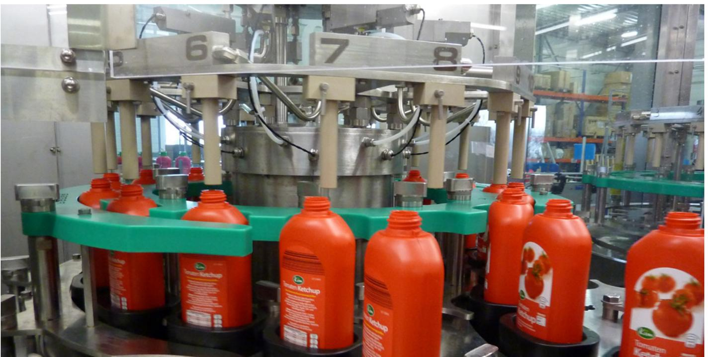
Figure 2 : Décontamination à sec des emballages juste avant le remplissage pondéral de ketchups
