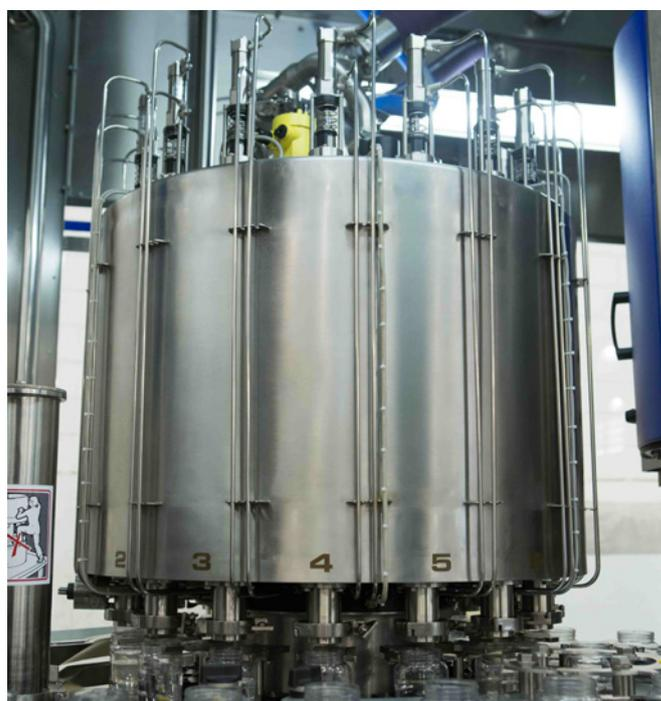
Figure 1: Le remplissage pondéral assisté par surpression pour les sauces très visqueuses
