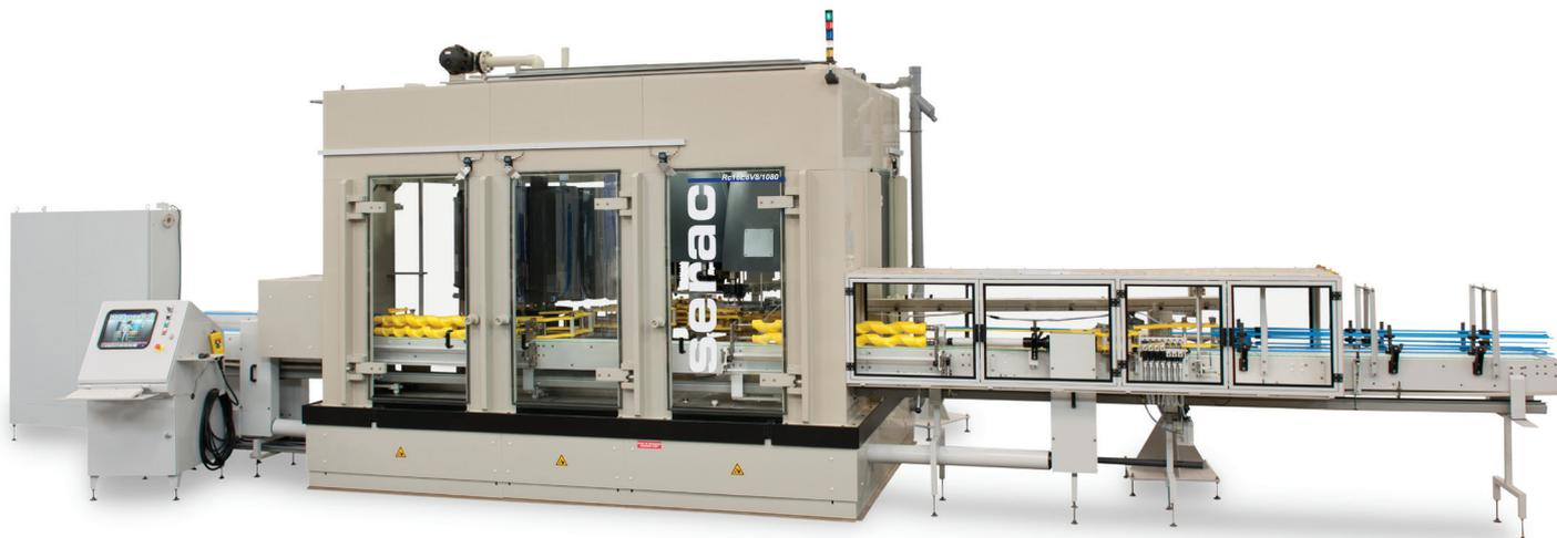
Remplisseuse-boucheuse réalisée avec des matériaux insensibles à la corrosion
