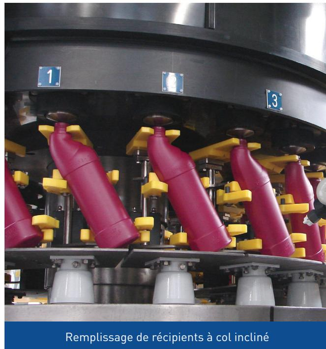
En concevant sa gamme de remplisseuses RC, Serac a aussi misé sur la flexibilité avec la technologie Plug-On® pour les changements de format. Les outillages Plug-on se montent et se démontent rapidement pour permettre la production de plusieurs formats sur la même machine.
